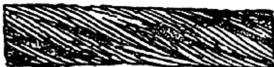
Рис. 2. Сочетание обрывов проволок с их износом: а — в канате крестовой свивки; б — в канате односторонней свивки
