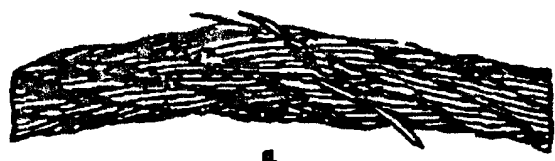
Рис. 2. Сочетание обрывов проволок с их износом: а — в канате крестовой свивки; б — в канате односторонней свивки
